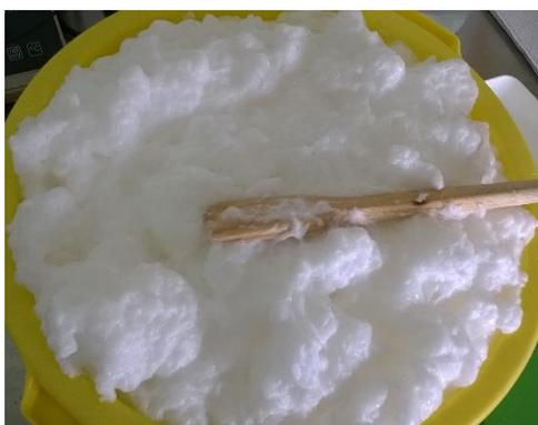
**Figura 5 - Formación de espuma durante los procesos de precipitación/neutralización.**
